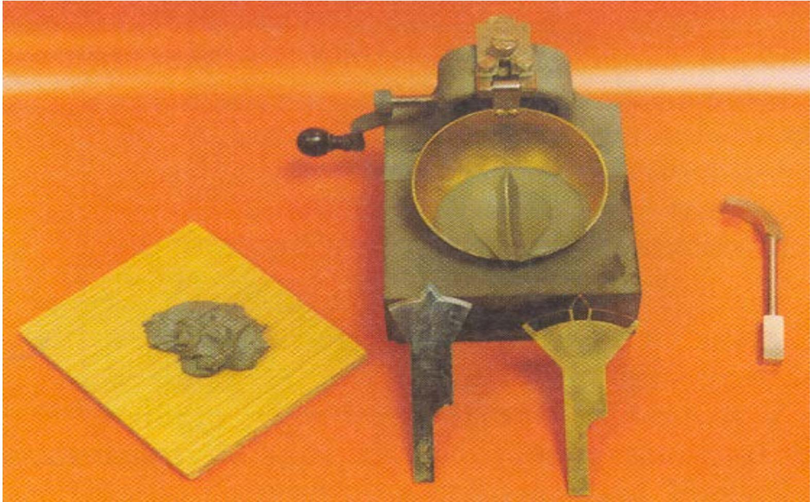
Para determinación del límite líquido. Se observa la arcilla amasada y colocada sobre la cuchara con el canal ya abierto. También pueden verse tres tipos de acanaladores usados en la práctica.
